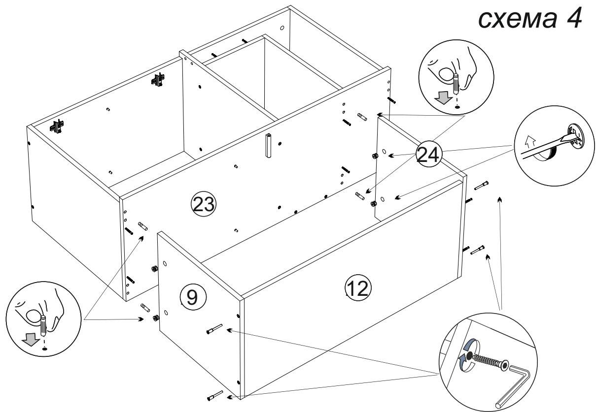
6. Установите деталь №10 на шканты и эксцентриковые стяжки на деталь №24, а затем так же при помощи шкантов и эксцентриковых стяжек установите деталь №14, как показано на схеме 5.
